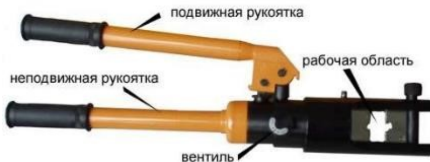
Рис.1 - Составные части опрессовщика кабеля
